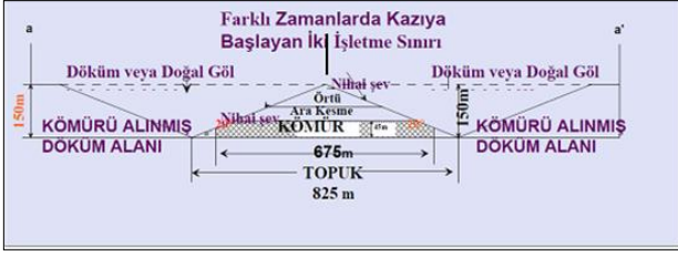
Şekil 10. Sektörler arası kömür topuğu kesit görünüşü [20]
