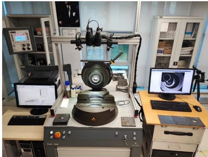
Şekil 3. Zwick/Roell BUP600 delik genişletme test cihazı
