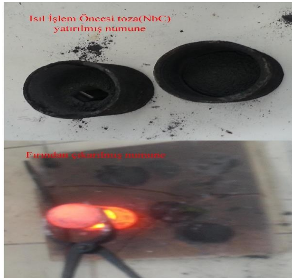
Şekil 1. Kaplama işlemine hazırlık ve kaplanmış numunenin fırından çıkarma işlemi
