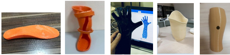
Şekil 4. Ankara Üniversitesi Ortez ve Protez Laboratuvarı 3B baskılı ortez ve protez üretimi: a) İşlem sırası b) Ürün örnekleri (tabanlık, suprakondiller AFO, WHO, TF soket, TT modüler protez kaplaması).
