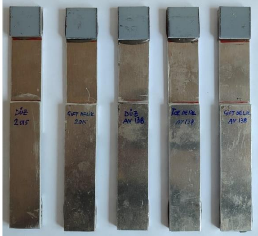
Şekil 4. Yapıştırma işlemi sonrası numuneler
