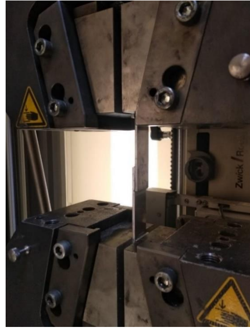
Şekil 5. Tek bindirmeli bağlantıların kayma testi
