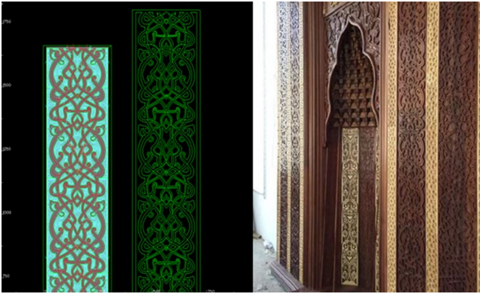
Şekil 20. Ahşap mihrap desenleri geometrik çizimi ve üretimi.
