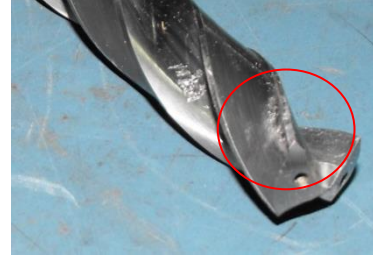
Şekil 7. GGG40 malzemesini kaplamasız karbür matkabın üzerine talaş yapışması
