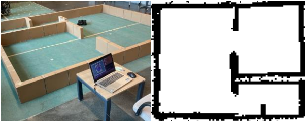
Şekil 6 Gerçek ortamda oluşturulan deney platformu (sol) ve bu platformun çıkarılan haritası (sağ).
