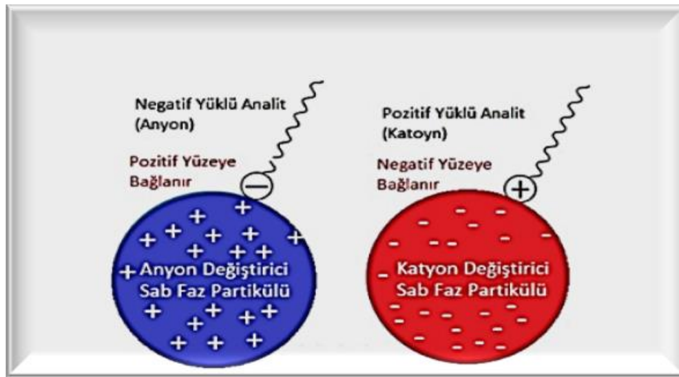
Şekil 2. İyon Değişim Kromatografisi Prensipleri ( https://labakademi.com/iyon-degisim-kromatografisi-genel-bakis-ion-exchange-chromatography/27.6.2024 )
