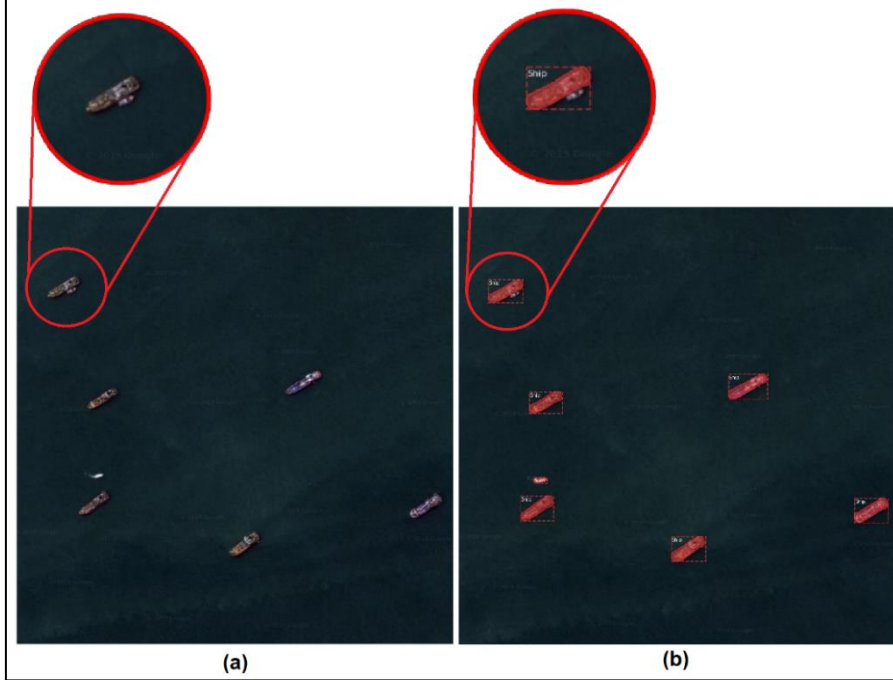
Şekil 4. Açık Denizde Bulunan Gemileri İçeren Bir Uydu Görüntüsü (a) ve Modelin Bu Görüntü İçin Ürettiği Tespit Sonucu (b)
