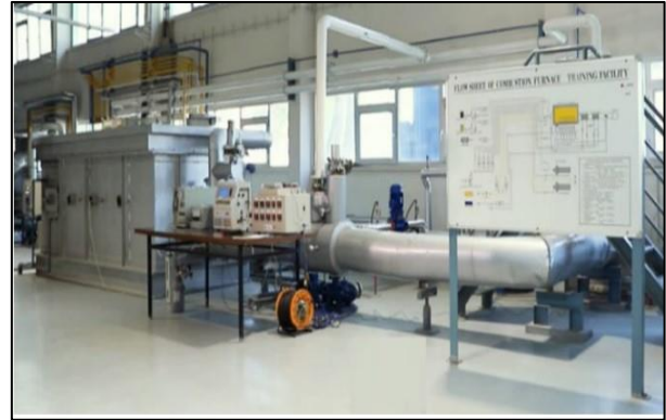
Şekil 23. Yakma fırını test ünitesi (Combustion furnace test unit) [357]
