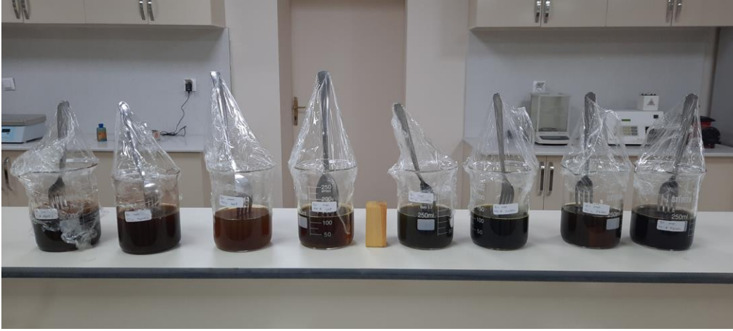
Şekil 5. Çam ahşaplar birlikte mordanlama yöntemiyle boyandıkları numune kapları
