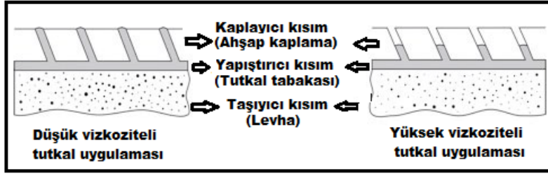
Şekil 7. Ahşap kaplamalı levhaların preslenmesinde tutkal viskozitesi ve nüfuz etkisi (Effect of glue viscosity and penetration to wood veneered panels on the pressing)
