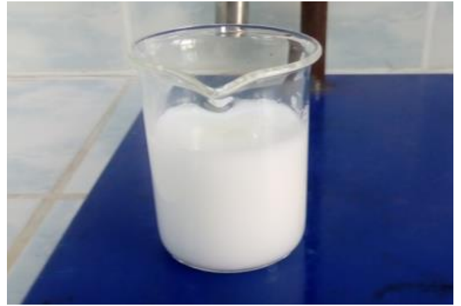
Şekil 5. Ultrasonik emülsifikasyon işleminden sonra yağ-su emülsiyonu, Güç: 28,5 watt/cm 2 , %10 yağ miktarı
