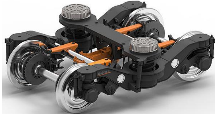
Şekil 7. TVS2000 yolcu vagonlarında kullanılan Y32 tipi boji [24]
