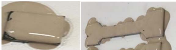
Şekil 1. Yapısal ve çekme test numunelerinin ön kaplama görüntüleri (Pre-coating images of structural and tensile test specimens)
