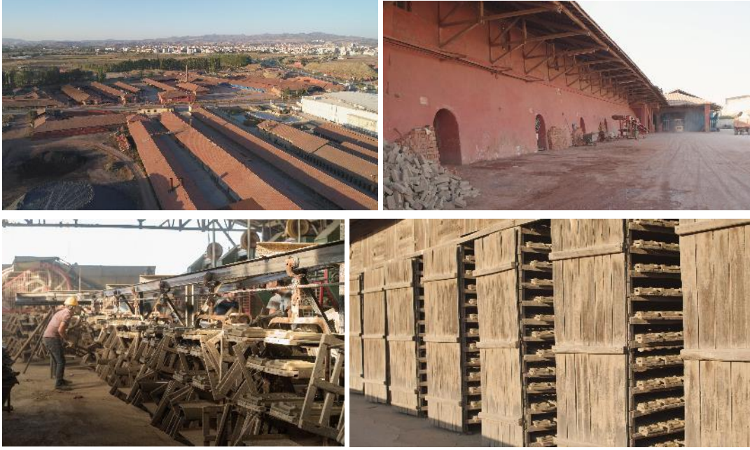
Fig. 8. Yüksel Kiremit Fabrikası ve çevredeki diğer kiremit fabrikaları, Yüksel Kiremit Fabrikası fırını; Yüksel Kiremit Fabrikası şekillendirme sonrası banda gönderimi, kurutma odaları.
