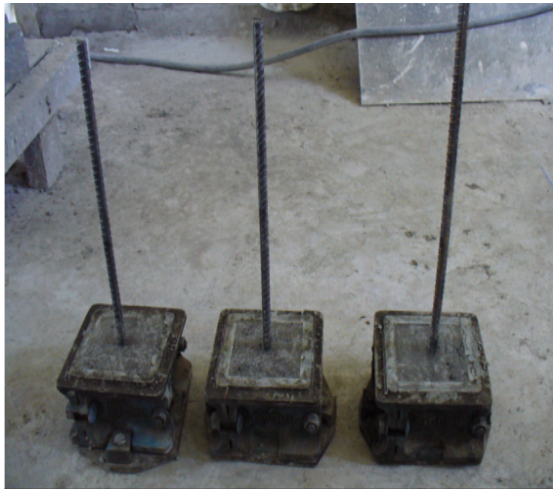
Resim 1. Nervürlü çeliğinin betona yerleştirilmesi (Putting of ribbed steel into concrete)
