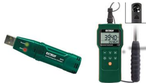
Figure 5. Measurement equipment - respectively from left to right: datalogger, anemometer. (Ölçüm aletleri - soldan sağa doğru sırasıyla: veri kaydedici ve anemometer.)
