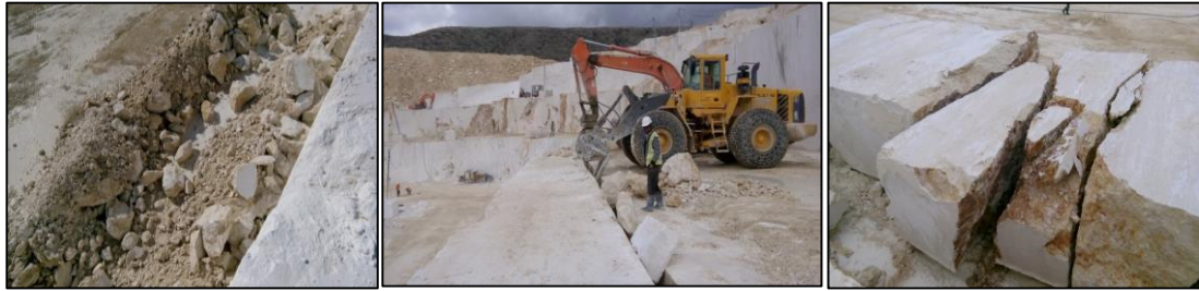
Şekil 11. Hazırlanan kesimin yıkım işleminden önce altına hafriyat ile beslenmesi, yıkılma ve yıkıldıktan sonraki görünümü. (View of the before and after turnover of the block)
