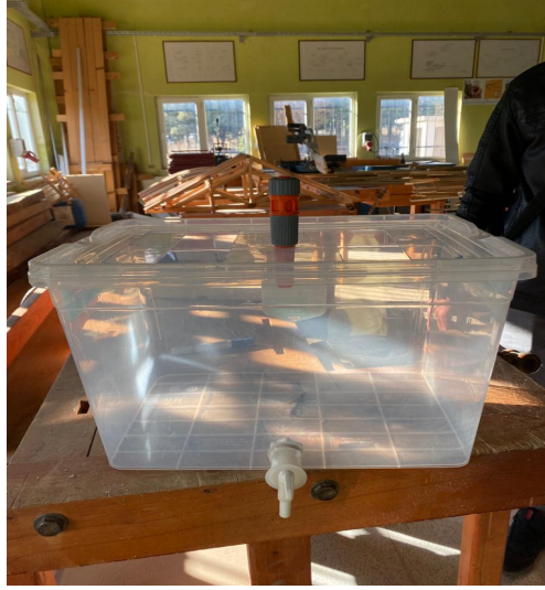
Şekil 2. Birim hidrograf deney aleti (Unit hydrograph experiment apparatus)
