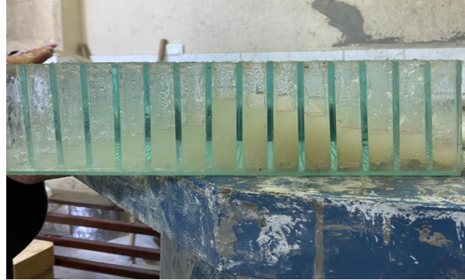
Şekil 11. İnce daneli taban malzemesi durumunda elde edilen su hacimleri (Water volumes obtained in the case of fine-grained bed material)
