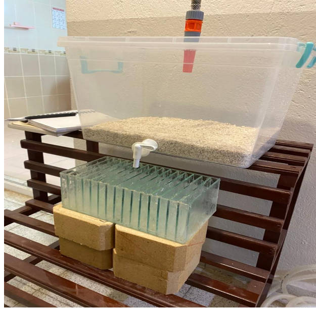
Şekil 4. Oluşturulan birim hidrograf deney aleti (Constructed unit hydrograph experiment apparatus)
