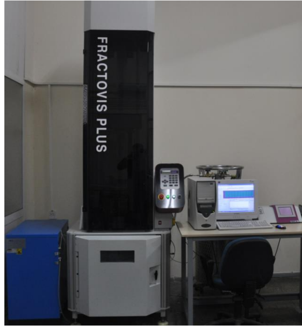
Şekil 2. CEAST 9350 (Fractovis Plus) darbe test cihazı
