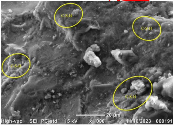
Şekil 14. K7Z15 numunesi SEM görüntüsü (SEM image of K7Z15 specimen)
