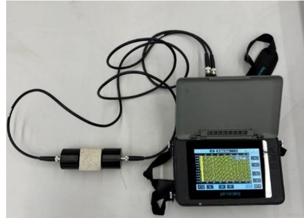
Şekil 2. Ultrases geçiş hızı deney düzeneği(Ultrasonic pulse velocity test setup)
