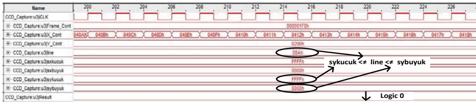
Şekil-12: Önerilen yöntemin FPGA’da gerçekleştirilmesi sırasında elde edilen sinyaller a) Ark oluşumun tespit edilmesinde alınan sinyal b) Ark oluşumunun olmadığı bir görüntü sırasında alınan sinyal
