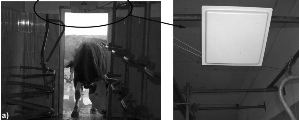
Şekil 3. Sağım tesisi girişinde yer alan RFID okuyucu Figure 3. RFID reader at the entrance to the milking facility
