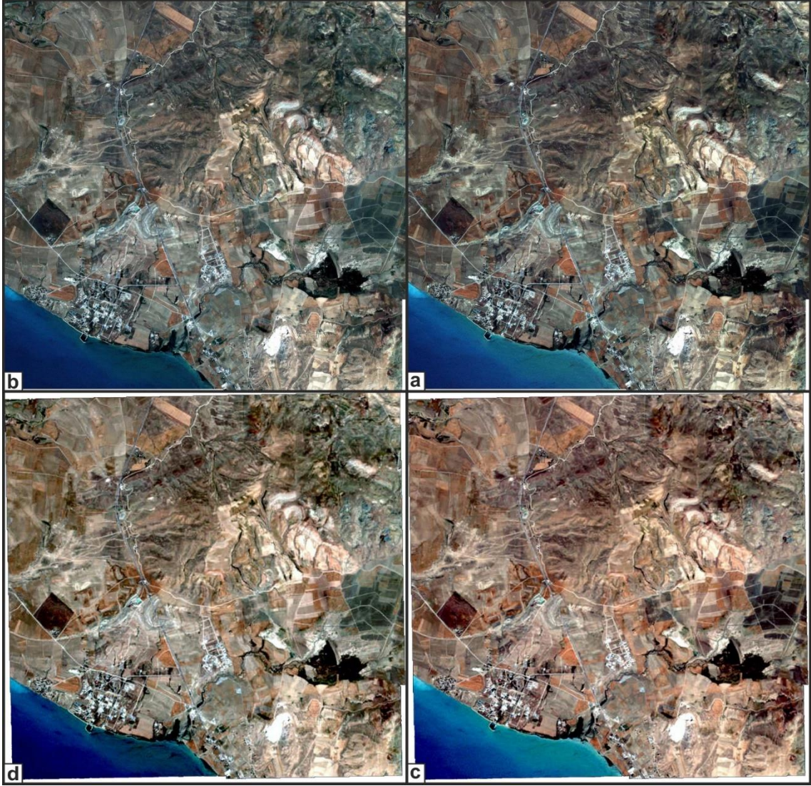
Şekil 7. Stereo-çift kaynak görüntüler. (a) Sağ bileşen; (b) sol bileşen (c) 1 m çözünürlükte yeniden örneklendirilmiş yer-atıflı sağ bileşen; (d) 1 m çözünürlükte yeniden örneklendirilmiş yer-atıflı sol bileşen.
