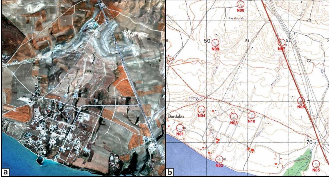
Şekil 12. İnceleme alanının görüntü dinamiği ayarı yapılmış orto-görüntüsü (a) ve inceleme alanına yönelik korelasyon fonksiyonu için seçilen nirengi noktalarının topografik harita üzerinde gösterimi (b).
