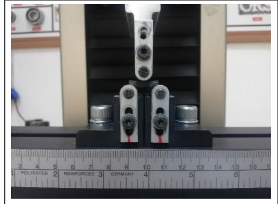
Şekil 4. Kısa kiriş kayma testi ve deney numunesi.
