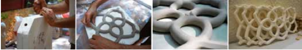
Görsel 14. Evaporatif seramik modül üretim süreci (http 23).
