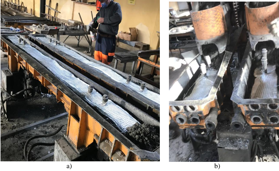
Şekil 2. Farklı donatılarla beton dökümü a) Cam elyaf dokuma kumaş b) Cam elyaf keçe kumaş
