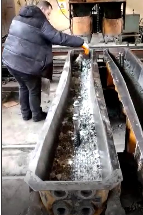
Şekil 3. Donatı olarak cam elyaf kırıntıları kullanılarak kalıplara beton dökümü
