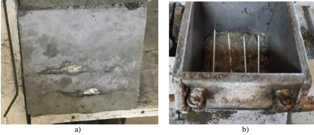
Şekil 4. Test küpleri ve hazırlanışı a) 12 mm kırpıntı cam elyaf b) Cam elyaf çubuk ile küp numunesi hazırlama
