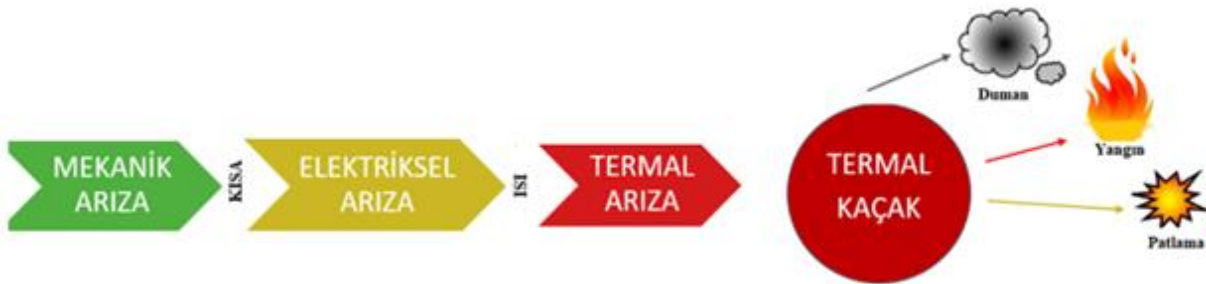
Şekil 3. Lityum iyon batarya arızaları ile ilişkili kazalar.
