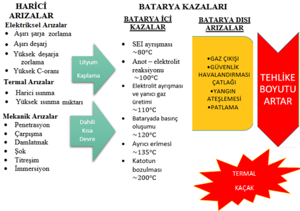
Şekil 1. Termal kaçak sürecine giren lityum iyon batarya arızasının aşamalarının detaylı şematik hali
