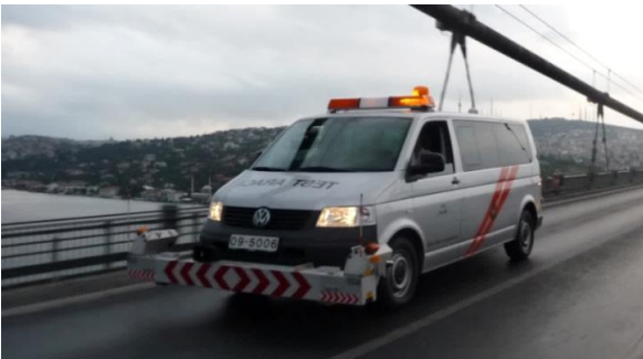
Şekil 1: Dynatest Mark-III profilometre cihazı.
