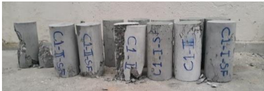
Şekil 6: Sargsız silindir numunelerin deney sonrası görüntüleri.
