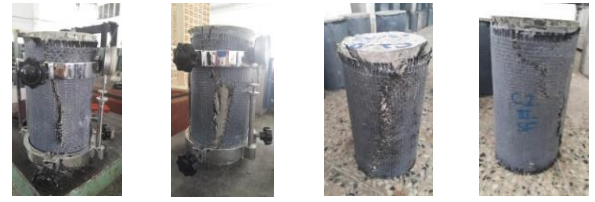
Şekil 9: CFRP sargılı bazı silindir numunelerine ait kırılma biçimleri.
