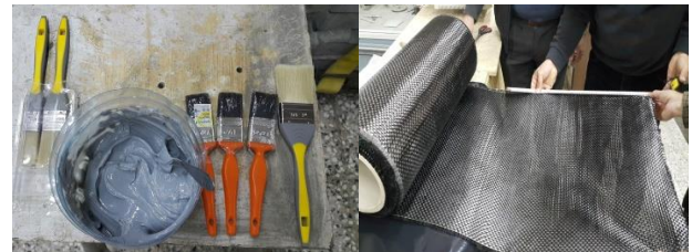
Şekil 1: Numunelerin sarılması için hazırlanan epoksi karışımı ve numunelere uygun ölçüde kesilen CFRP kumaşı.
