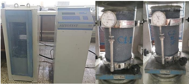
Şekil 3: Deney düzeneği ve düzeneğe yerleştirilen bazı silindir numune örnekleri.
