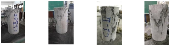
Şekil 7: Sargsız bazı silindir numunelerine ait kırılma biçimleri.
