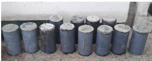
Şekil 8: CFRP sargılı silindir numunelerin deney sonrası görüntüleri.
