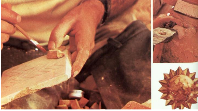
Şekil 15: Fırınlanan karoların sırlı yüzeylerine şablon yardımıyla desenlerin aktarılması. 81
