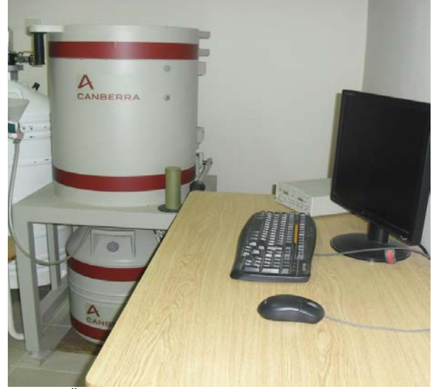
Şekil 2. Ölçümlerde kullanılan gama ışın spektrometresi
