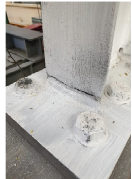
Şekil 3.13 - TB.1.17.L Kuvvet-Öteleme Açısı döngüsü ve flanş kesitinde kırılma (Ç.31).
