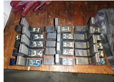
Şekil 2.7 - IPE270 S275JR kiriş gövde ve flanş için çekme numuneleri ile kaynak makro test numuneleri
