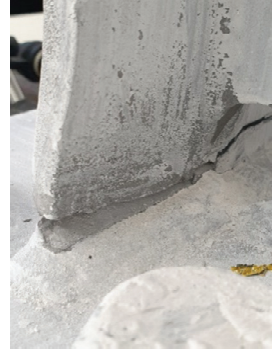
Şekil 3.14 - TB.1.18.L Kuvvet-Öteleme Açısı döngüsü ve flanş kesitinde kırılma (Ç.32).
