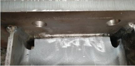
Şekil 2.6 - Kök paso sonrası temizlik ve pasolar arası sıcaklık ölçümleri.
