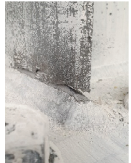
Şekil 3.16 - TB.1.24 Kuvvet-Öteleme Açısı döngüsü ve flanş kaynağında kırılma (Ç.29).
