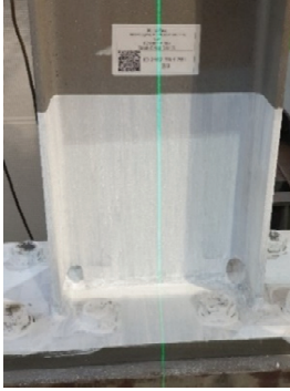
Şekil 3.20 - TB.1.28.L Kuvvet-Öteleme Açısı döngüsü ve flanş kaynağında kırılma (Ç.32).
