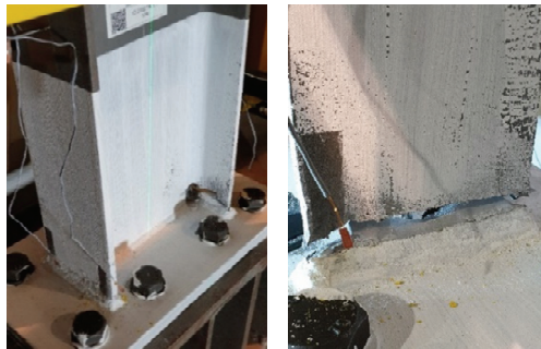
Şekil 3.4 - TB.1.1 çevrim sayısı 27, flanş kaynağında kırılma.
