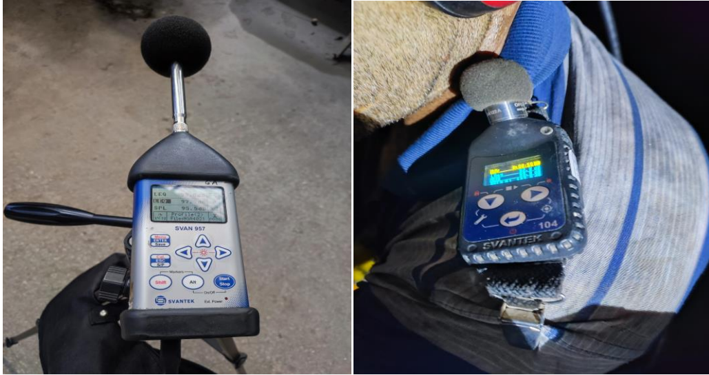
Şekil 1. İç ortam gürültü ölçümlerinde kullanılan Svantek-957 marka (solda) ve gürültü ölçümü için kullanılan Svantek-Sv104 marka dozimetre cihazları (sağda)
