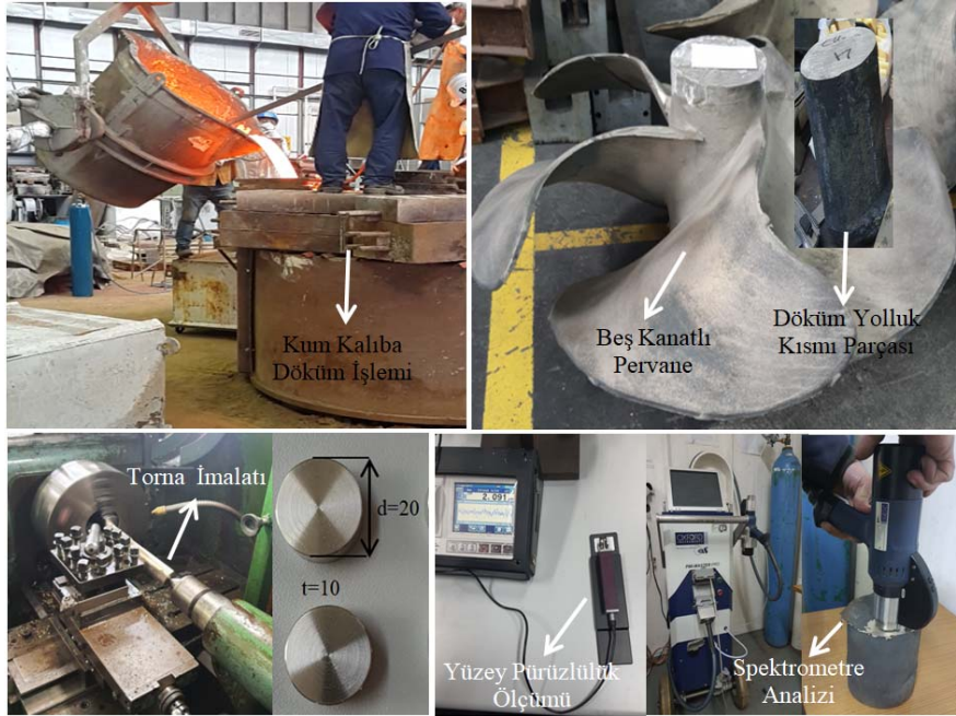
Şekil 1. MAB-CU4 numune dökümü ve kavitasyon erozyon testleri için hazırlanması (Casting of MAB-CU4 sample and preparation for cavitation erosion tests)
