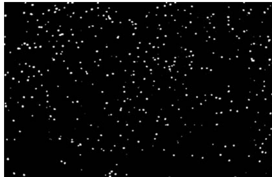
Şekil 7. LR-115 film detektörlerdeki Radon- alfa izleri Figure 7. Radon-alpha tracks in LR-115 film detectors.
