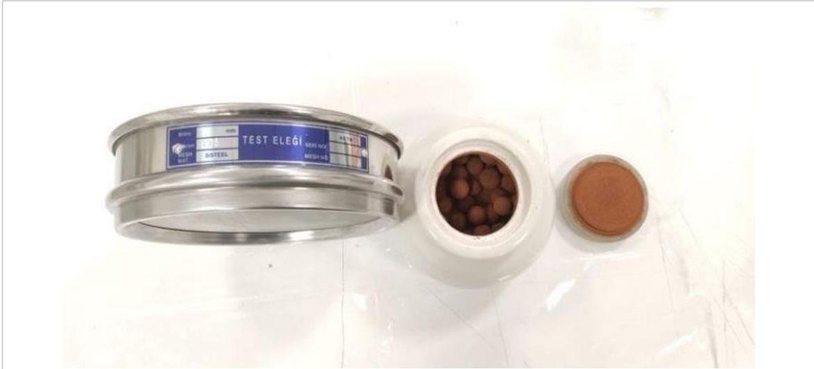
Görsel 6: Toz pigmentlerinin değirmende kuru çevirme işlemi görmesinin ardından 125 mikron elekten geçirilmesi işlemi.
