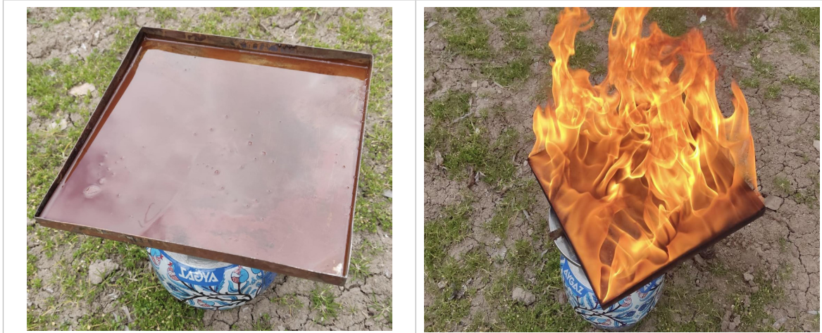
Görsel 1-2: Kahverengi atık boyanın çelik tepside ısı işlemine tabi tutulması ve ısı verilen solvent bazlı dijital baskı boyasının alev alması.
