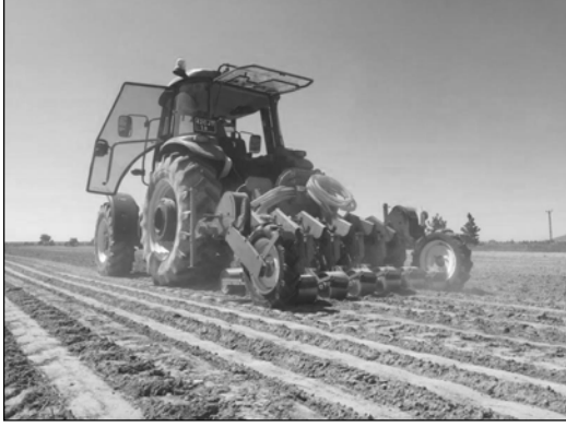
Şekil 3. Pnömatik hassas ekim makinasıyla dallı darı ekimi Figure 3. Switch grass sowing with the pneumatic precision sowing machines
