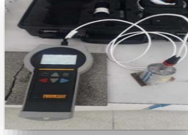
Şekil 3. Numunelerin ısı ve ses değerlerinin ölçümü
