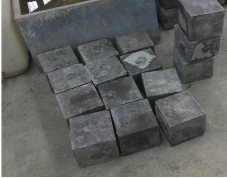
Şekil 2. Beton küp numuneler
