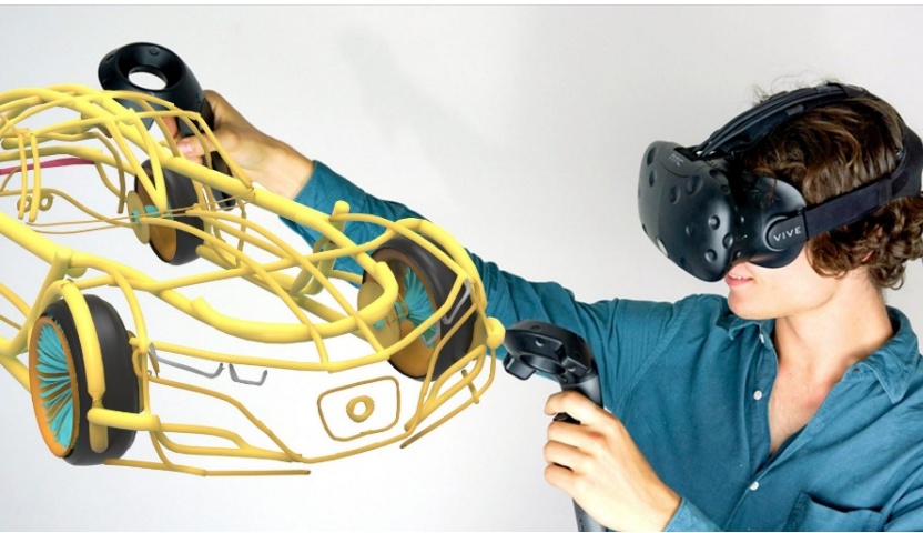
Görsel 4. Sanal gerçeklik kaskı ve dokunmatik kontrol donanımlarını kullanarak Gravity Sketch yazılımında üç boyutlu model oluşturan tasarımcı (Dezeen, 2024)
