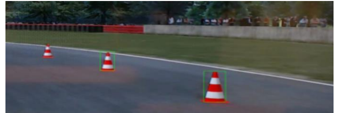
Şekil 4. Görüntü üzerinden huni ile şerit tespiti [14]
