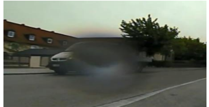
Şekil 5. Su damlasından etkilenmiş kamera görüntüsü [21]
