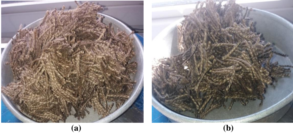
Şekil 1: a) Grafen oksit kaplamasız jüt lif, b) Grafen oksit kaplamalı jüt lif
