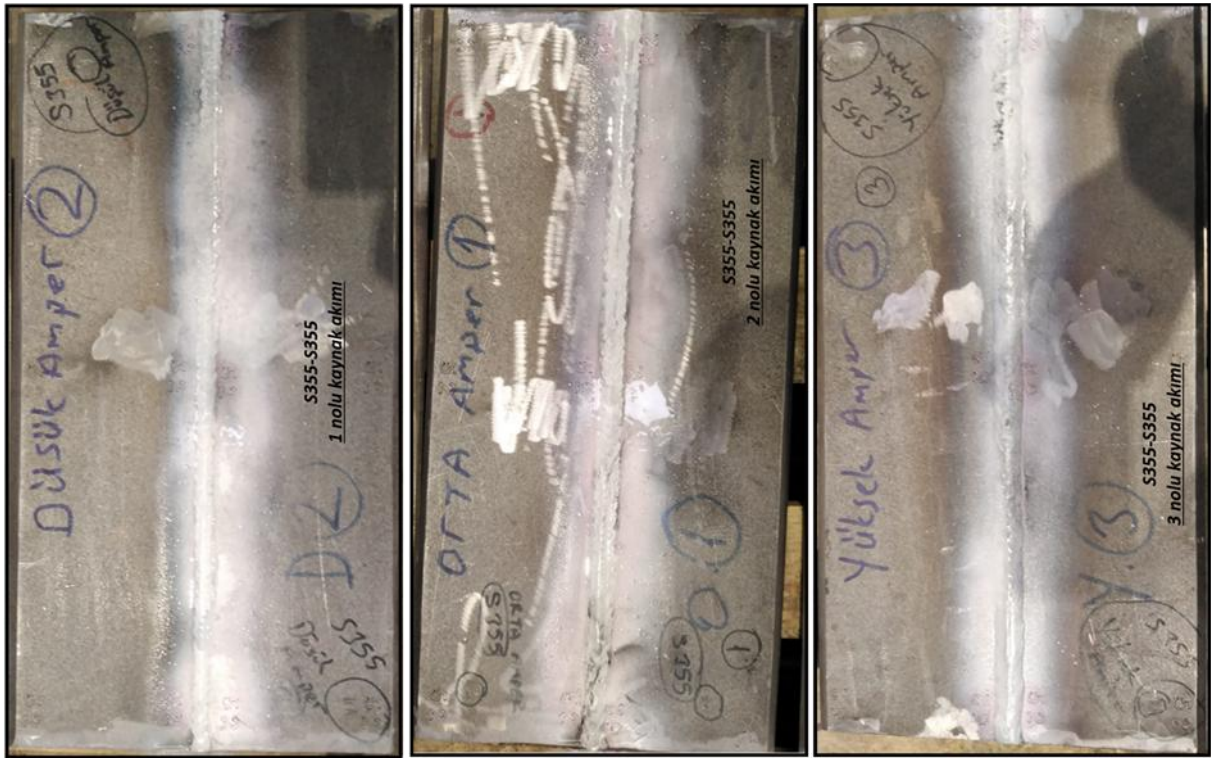
Şekil 9. S355-S355 1, 2 ve 3 numaralı parametreler kullanılan numunenin MT görüntüsü (S355-S355 MT image of the sample using parameters number 1, 2 and 3)
