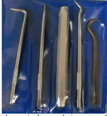
Şekil 14: Destek malzemesi çıkarma aleti ve yüzeyde oluşan deformeler
