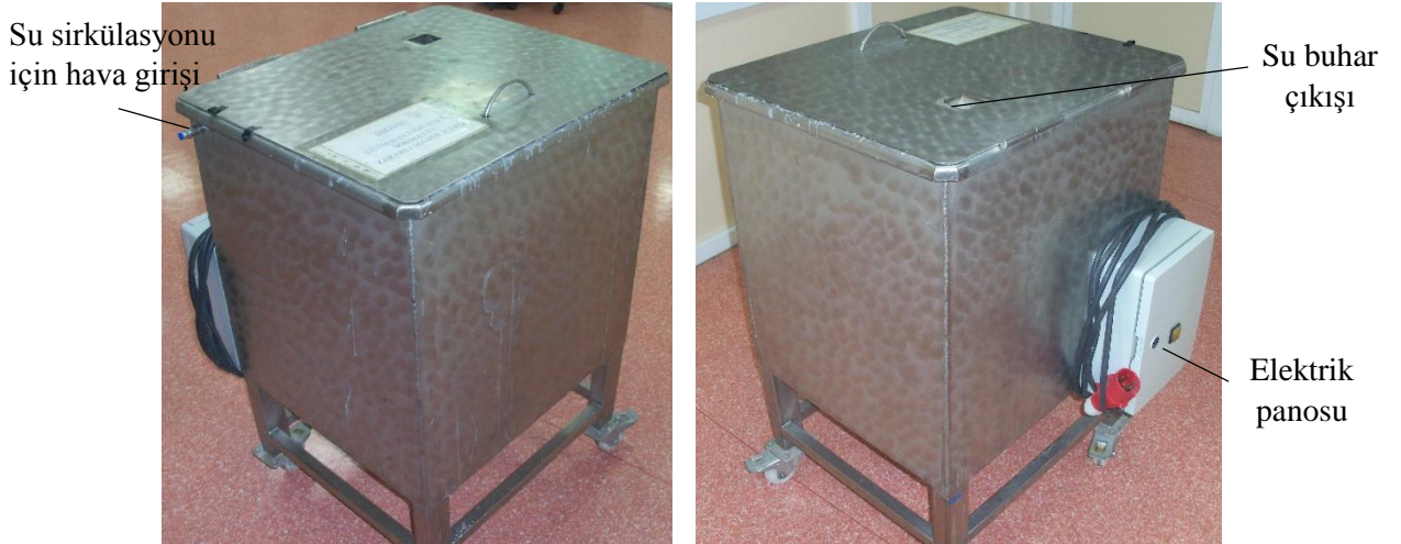
Şekil 15: Destek malzemesi çıkarma havuzu
