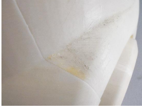
Şekil 8: Prototip imalatından sonra destek malzemenin çıkartılmasında oluşan deformeler
