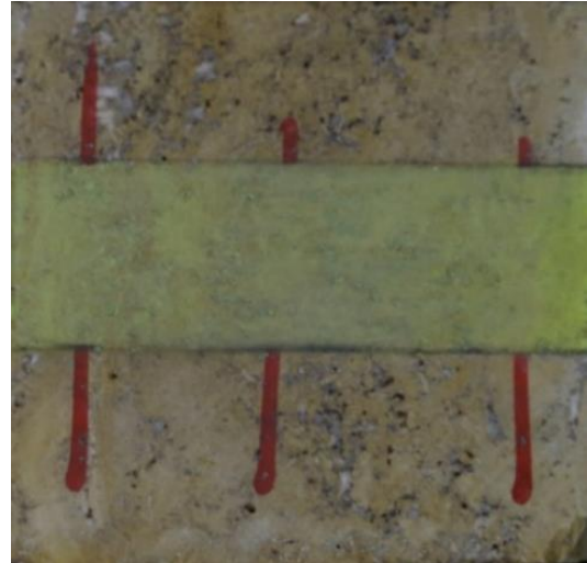
Şekil 5. Geniş disk aşınma deneyi sonrası T-3-1 (Denizli Akköy sarı traverten) örneğinin görünümü.
