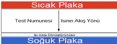
Şekil 2: Hot plate metodu ile ölçüm.
