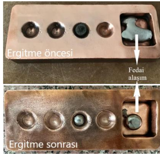
Şekil 4. Vakum ark ocağında ergitme öncesi ve sonrası master alaşım numunesi. a) Ergitme öncesi master alaşımı b) Ergitme sonrası master alaşımı
